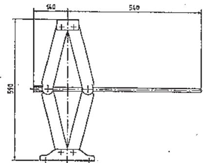
Die Scherenstützen sind paarweise am Fahrzeugrahmen zu montieren und daher nicht zum Reifenwechsel geeignet.
