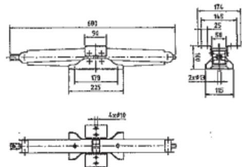
**Die Scherenstützen sind paarweise am Fahrzeugrahmen zu montieren und daher nicht zum Reifenwechsel geeignet.**
