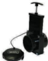
Schiebeventil 3" mit 3" Bajonettauslaß und Deckel sowie 3" Einlaß ohne Gewinde für Gegenstück Nr. 6910007 zum Einkleben oder Gegenstück Nr. 6910015 für Bajonettaufnahme
